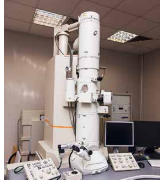
Просвечивающий электронный микроскоп обладает разрешающей способностью, позволяющей рассмотреть кристаллическую решетку изучаемого образца
