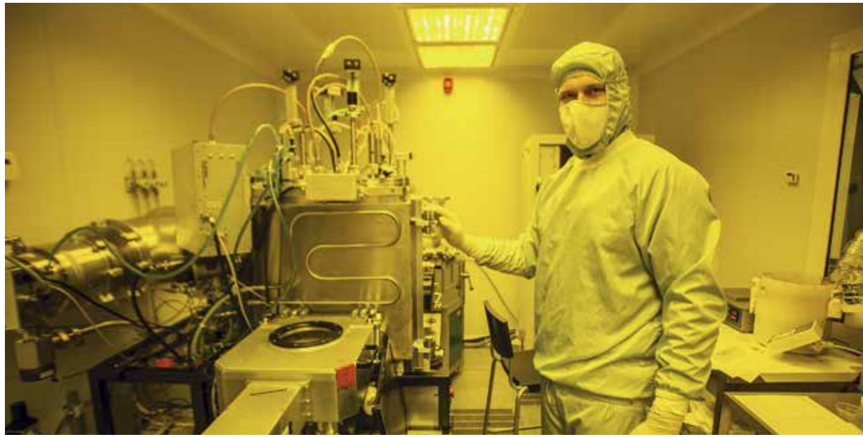
Чистая зона относится к Центру коллективного пользования МФТИ, с которым кафедра активно сотрудничает, так же как и с другими лабораториями. Здесь находятся установки для формирования специального покрытия для схем (чипов) или кремниевых пластинок. Сначала наносят пленку (например, из меди), а затем на ней создается рисунок, который может быть различным в зависимости от задачи.
