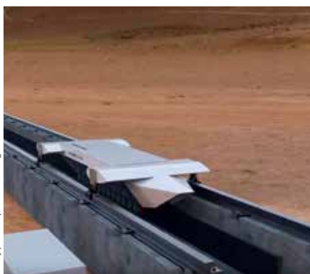
«Санки», которые использовались для испытания новой системы, разогнались почти до 200 км/ч чуть больше, чем за секунду
