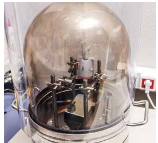
Элемент оборудования пробоподготовки для просвечивающего электронного микроскопа
