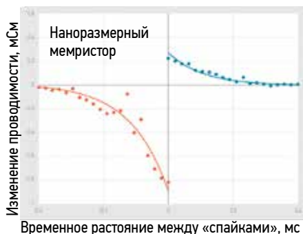
Изменение проводимости мемристоров в зависимости от временного расстояния между «спайками» (вверху) и изменение потенциала на биологических синапсах (внизу)
